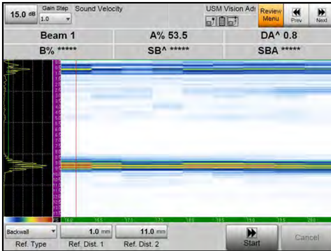
Figura 27: Medición de velocidad del sonido
