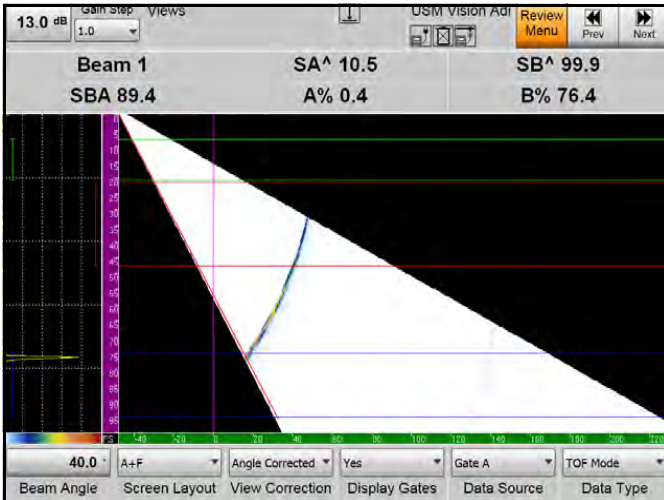
Figura 61: Verificación de la calibración a 40° (99,9 mm)
