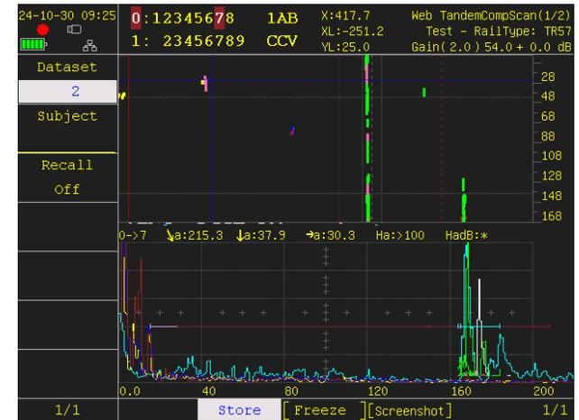
Desde el área de rodamiento, el sistema permite de manera fácil y dinámica la detección de defectos en la soldadura orientados perpendicularmente a la superficie de rodamiento, utilizando un arreglo Tandem de 12 transductores. En la imagen se muestran indicaciones de una soldadura con falta de fusión.
