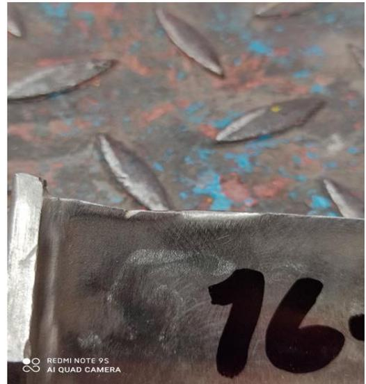
Fig. 7. Visualmente se observan indicaciones de deformaciones en el perfil de álabes móviles.
