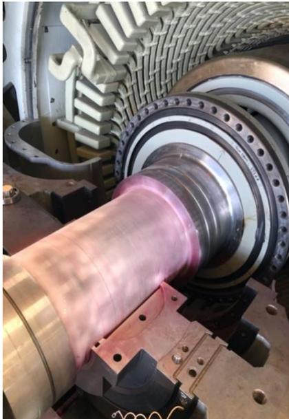
Fig. 24. Inspección con el método de líquidos penetrantes colorantes.
