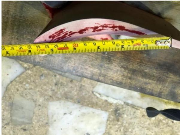
Fig. 10. Con el método de líquidos penetrantes colorantes de forma superficial se observan indicaciones lineales.
