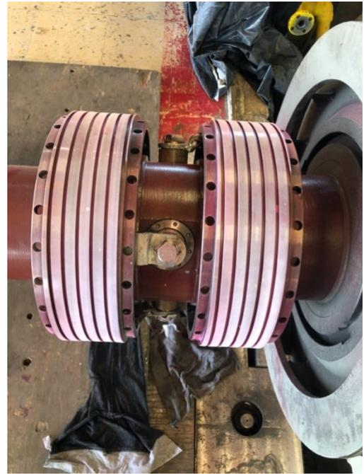
Fig. 25. Inspección con el método de líquidos penetrantes colorantes
