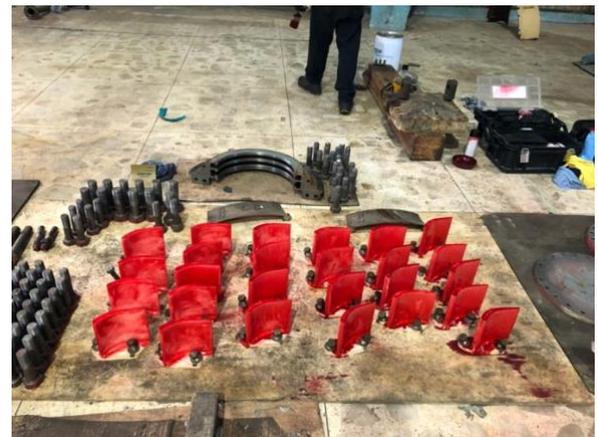
Fig. 9. Aplicación del método de líquidos penetrantes colorantes.
