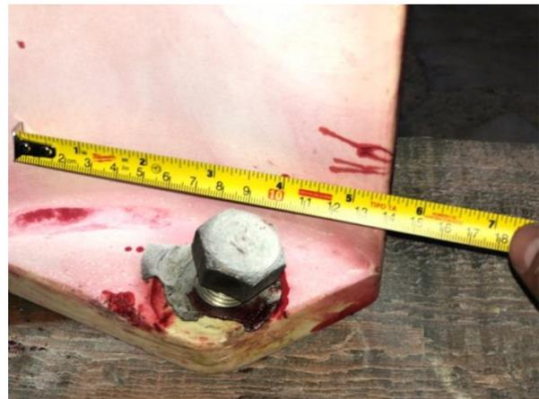
Fig. 11. Con el método de líquidos penetrantes colorantes de forma superficial se observan indicaciones lineales.
