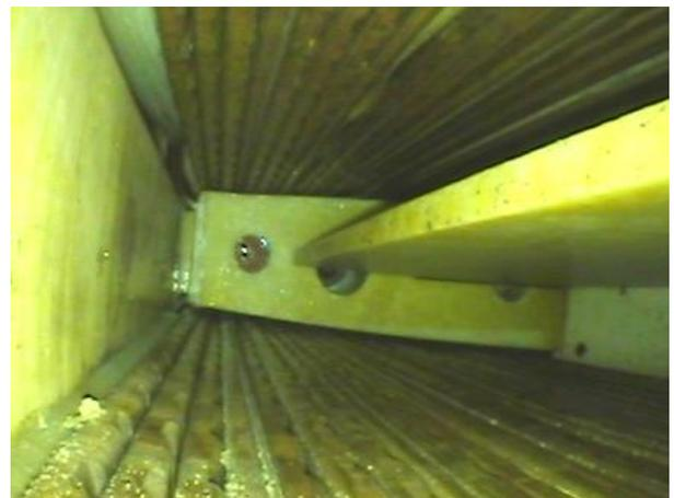
Fig. 13. Inspección visual remota en zona de cuñas.
