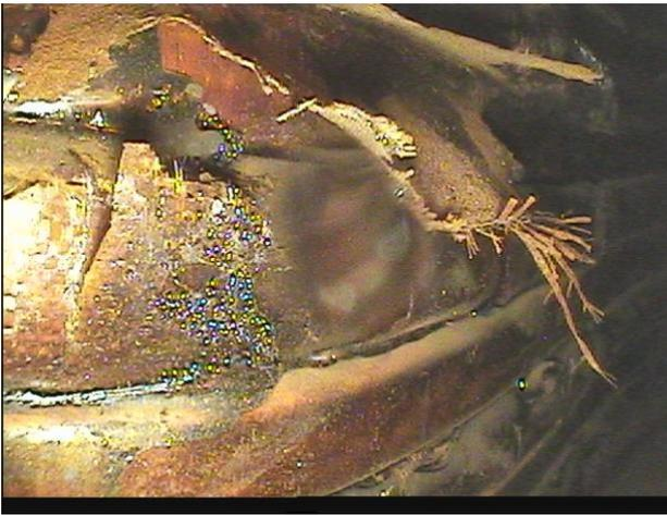
Fig. 18. Se observan indicaciones de pérdida de material aislante de forma significativa.
