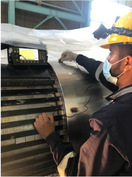
Fig. 23. Inspección del anillo de retención mediante el método de ultrasonido industrial.
