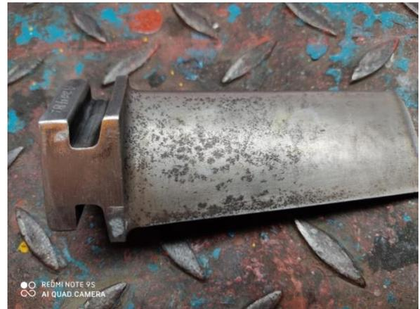
Fig. 8. Visualmente se observan de corrosión superficial.
