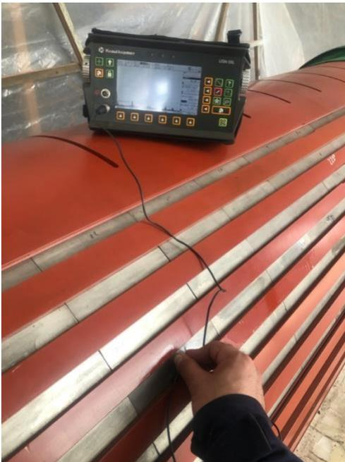
Fig. 15. Aplicación del método de ultrasonido industrial.
