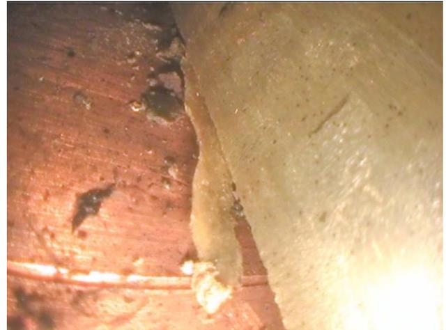
Fig. 16. Con el método de inspección visual remota, se observaron indicaciones de factura de material de los separadores de aislante (baquelita).
