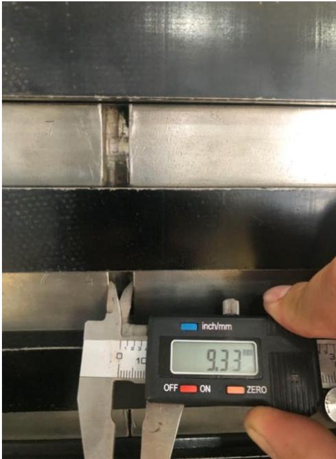
Fig. 14. La imagen ilustra el desplazamiento axial .
