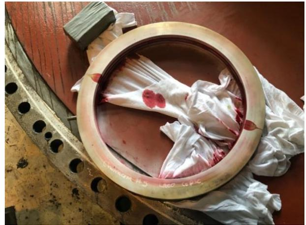
Fig. 12. Aplicación de los métodos superficiales en sellos de hidrógeno.
