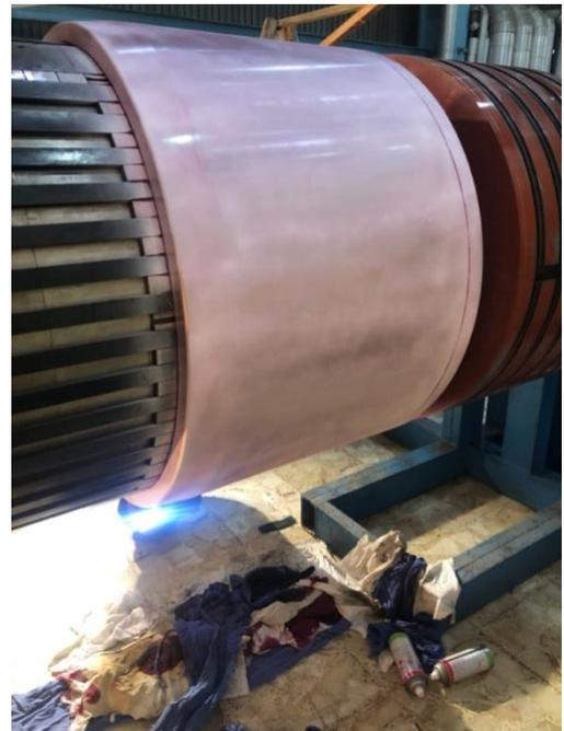
Fig. 22. La imagen ilustra el proceso de revelado mediante el método de líquidos penetrantes.
