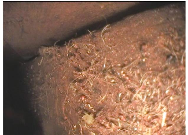
Fig. 17. Se observaron indicaciones de escombros y suciedad en la parte interna del anillo de retención.
