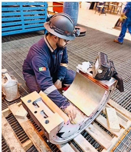
Fig. 3. Aplicación del método de ultrasonido industrial para la verificación de adherencia entre materiales.
