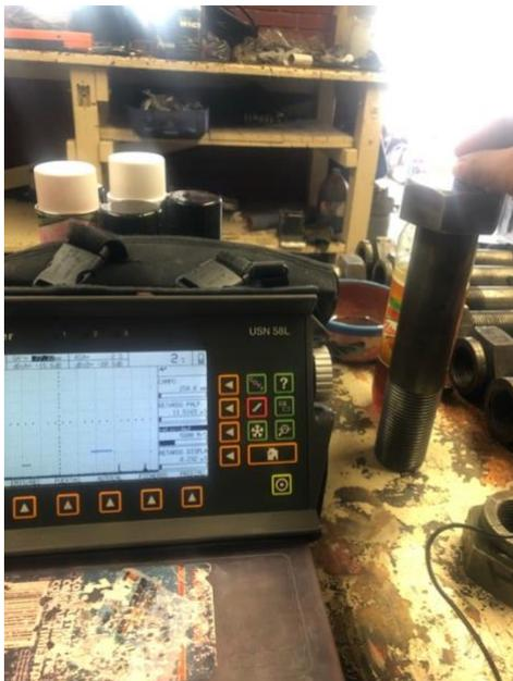
Fig. 2. La imagen ilustra la inspección de los pernos mediante los métodos de ensayos no destructivos.
