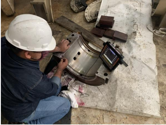
5. Inspección de un segmento superior de chumacera de carga por el método de ultrasonido con haz recto.
