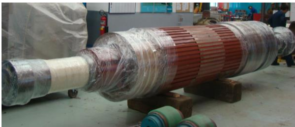
1. Rotor de generador eléctrico con capacidad de 158 MW
