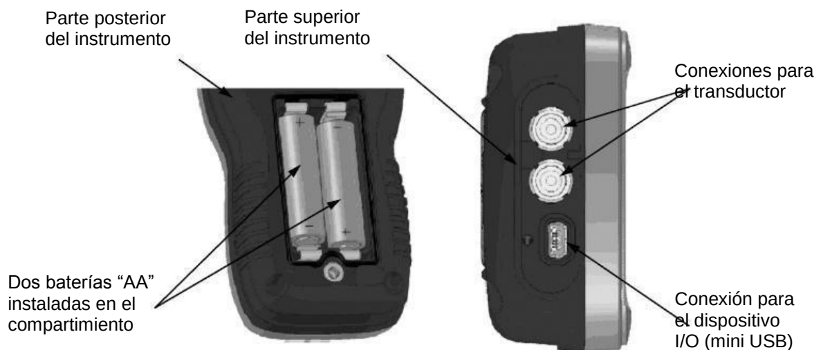
Figura 33: Compartimiento de las baterías y conexiones del instrumento.
