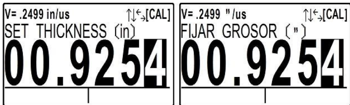
Figura 30: Pantalla para introducir el espesor de referencia
