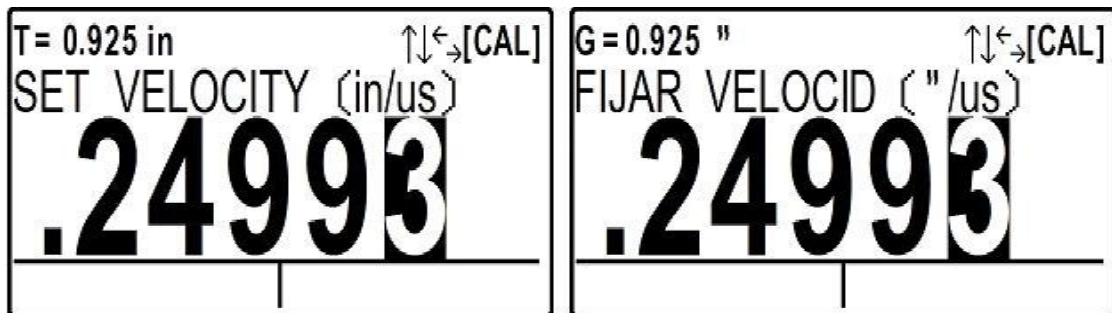
Figura 25: Pantalla para el ajuste de la velocidad del ultrasonido.
