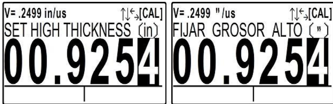
Figura 24: Pantalla para introducir el espesor mayor de referencia.
