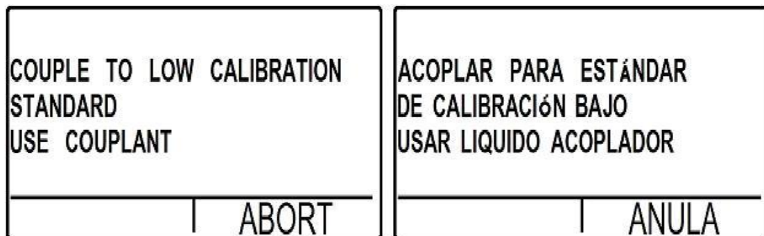
Figura 17: Pantalla con la instrucción para acoplar el transductor en el espesor menor
