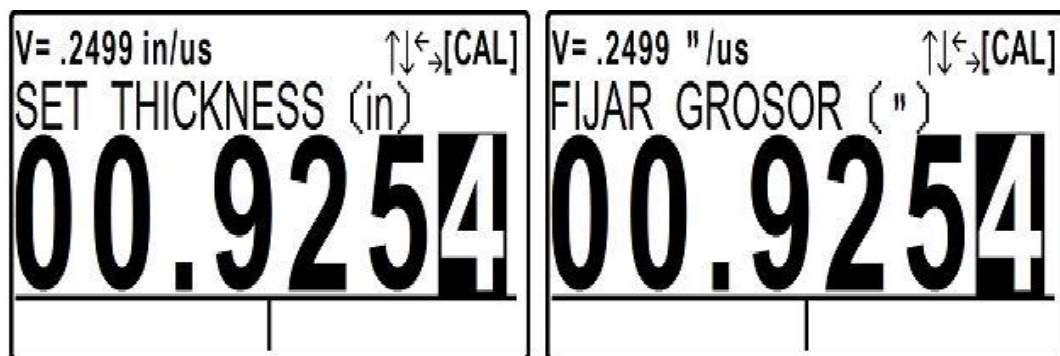
Figura 14: Pantalla para introducir el espesor de referencia
