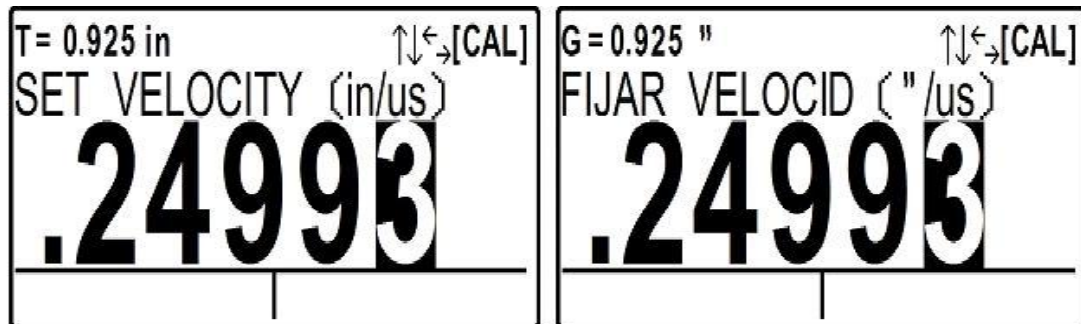
Figura 31: Pantalla para el ajuste de la velocidad del ultrasonido
