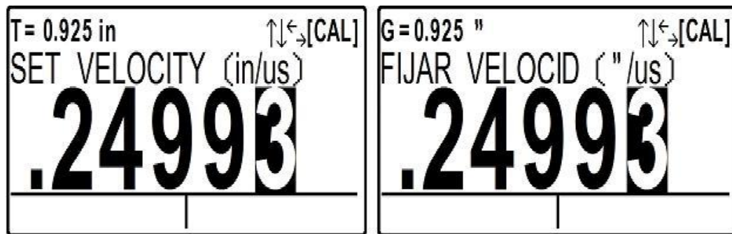
Figura 15: Pantalla para el ajuste de la velocidad del ultrasonido.
