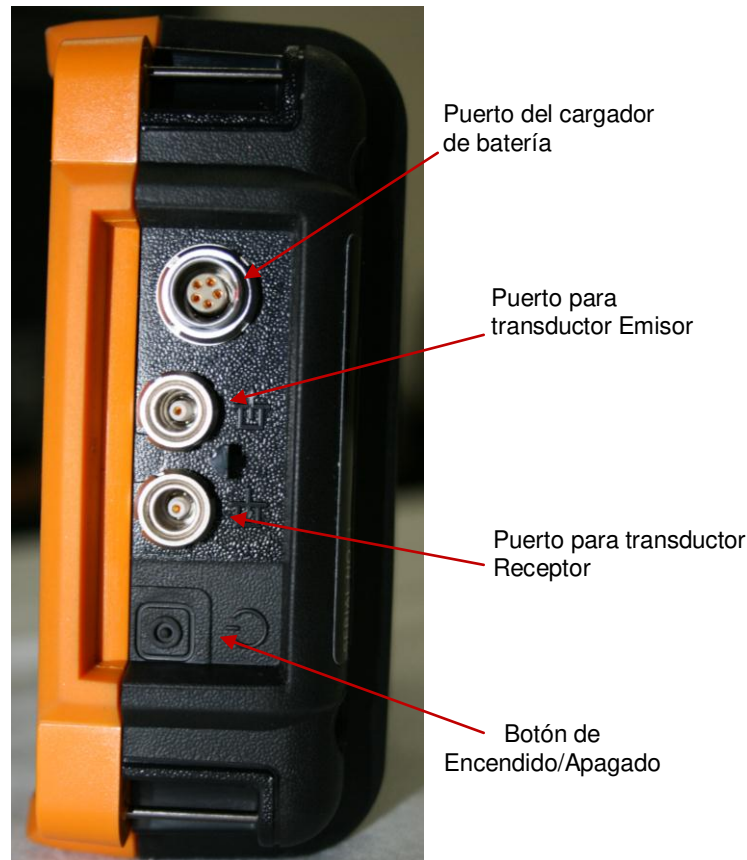
Figura 7.- Puertos de conexión del DMS Go
