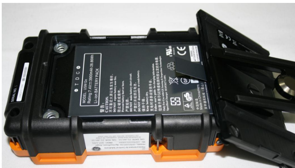
Figura 6.- Compartimiento de baterías
