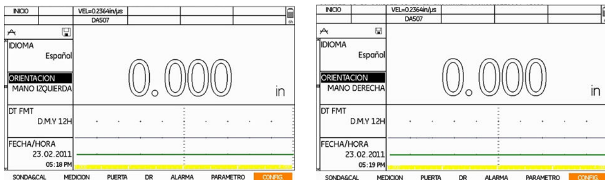
Figura 19.- Ajuste de orientación de pantalla
