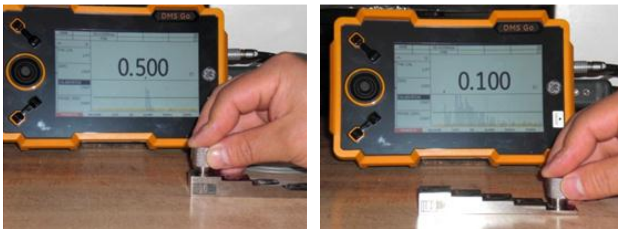
Figura 39.- Comprobación de la calibración
