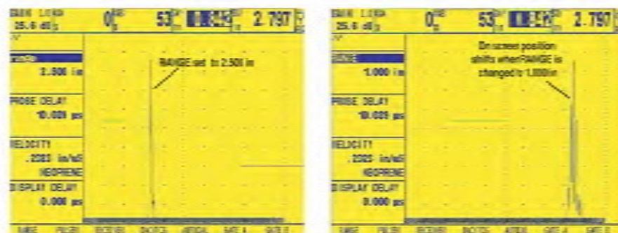
Figura 13: Efectos del ajuste del rango en el Barrido A
