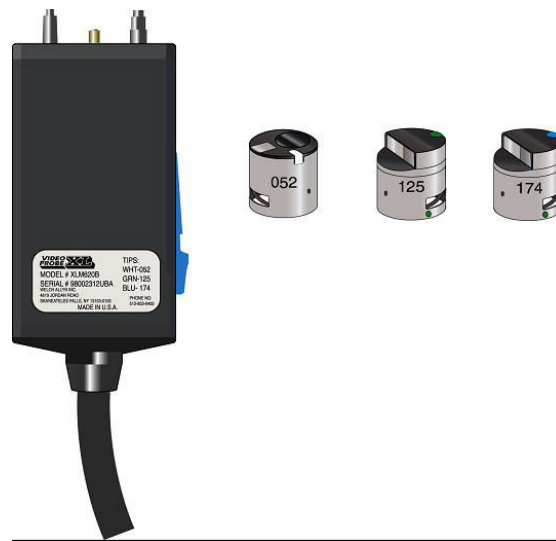
Figura 38 identificacion de puntas de medicion por sombras
